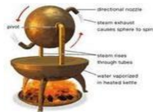
Εικ.5 Ατμοστρόβιλος του Ήρωνα
