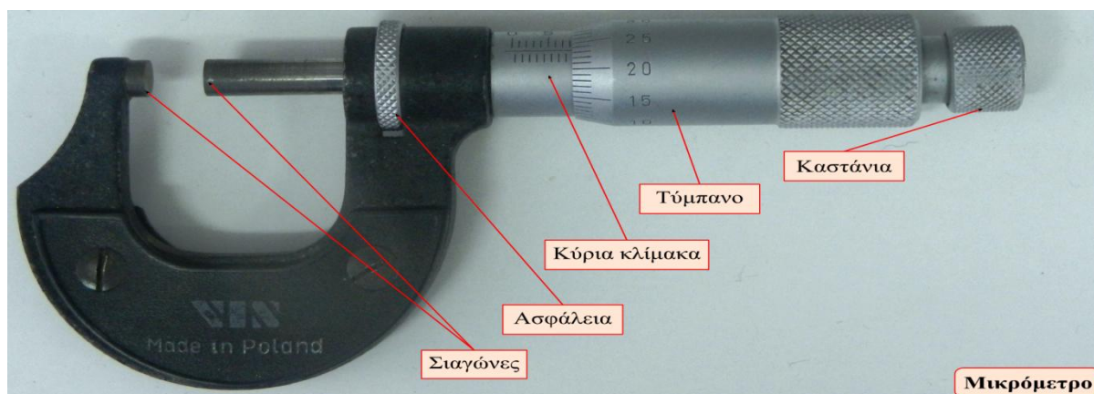
Εικόνα 7 Μέρη μικρόμετρου.
