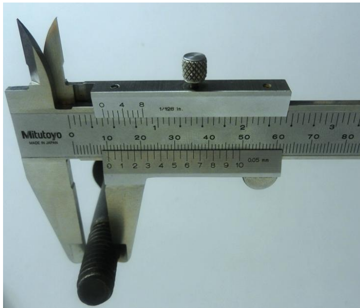
Εικόνα 3 Μέτρηση σπειρώματος με παχύμετρο.
