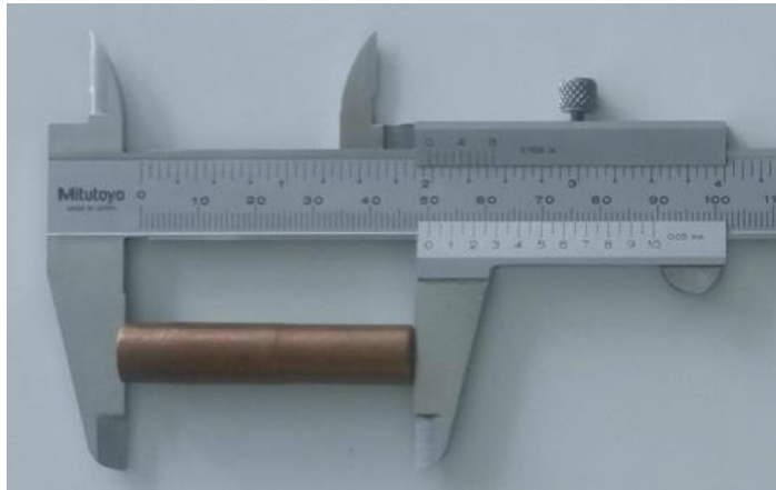
Εικόνα 2 Μέτρηση μήκους με παχύμετρο.
