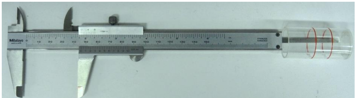
Εικόνα 5 Μέτρηση βάθους με παχύμετρο.
