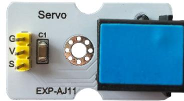
Η συσκευή αυτή είναι συσκευή διασύνδεσης – επέκτασης του σετ. Χρησιμοποιείται για τη σύνδεση διάφορων συσκευών, όπως ο σερβοκινητήρας και το laser. Ουσιαστικά μετατρέπει τη σύνδεση της συσκευής από τρισύρματη σε RJ11, και με αυτό το τρόπο μπορεί εύκολα να συνδεθεί στον ελεγκτή ARD:icon με καλώδιο τύπου UTP. Επίσης, σε συνδυασμό με πλακέτα ανάπτυξης κυκλωμάτων (breadboard), μπορείτε να συνδέσετε ηλεκτρονικά στοιχεία με τον ελεγκτή ARD:icon.
