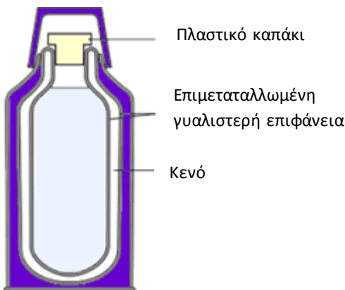
Εικόνα 1: Τα μέρη του θερμός
