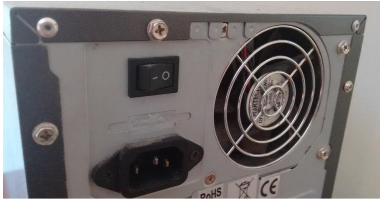
Σχ. 2.2 Διακόπτης τροφοδοσίας (κλειστός)
